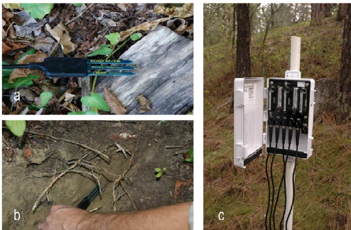
Fig. 68. Sistema di acquisizione dei dati relativi alla temperatura ed umidità del suolo: a) sonda, b) inserimento della sonda nel suolo a 20 cm di profondità, c) centralina di raccolta dati.
