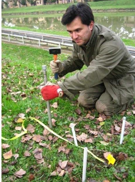
Fig. 41. Prelievo dei campioni di suolo. Tre tubi in PVC sono stati piantati nel terreno senza l'ausilio del carotatore, mentre per il quarto l'operatore sta utilizzando il carotatore in acciaio.
